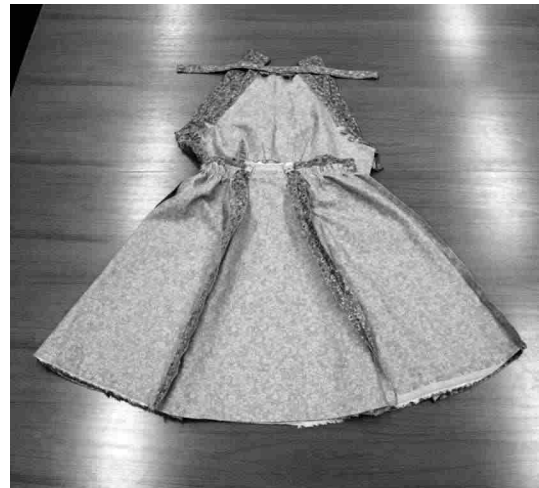
写真17 スカートと身頃を接ぎ合わせて、縫い代を身頃の方に片返す
